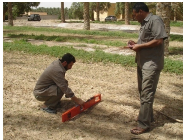
استعمال جهاز EM38 لقياس الملوحة بالحقل.
