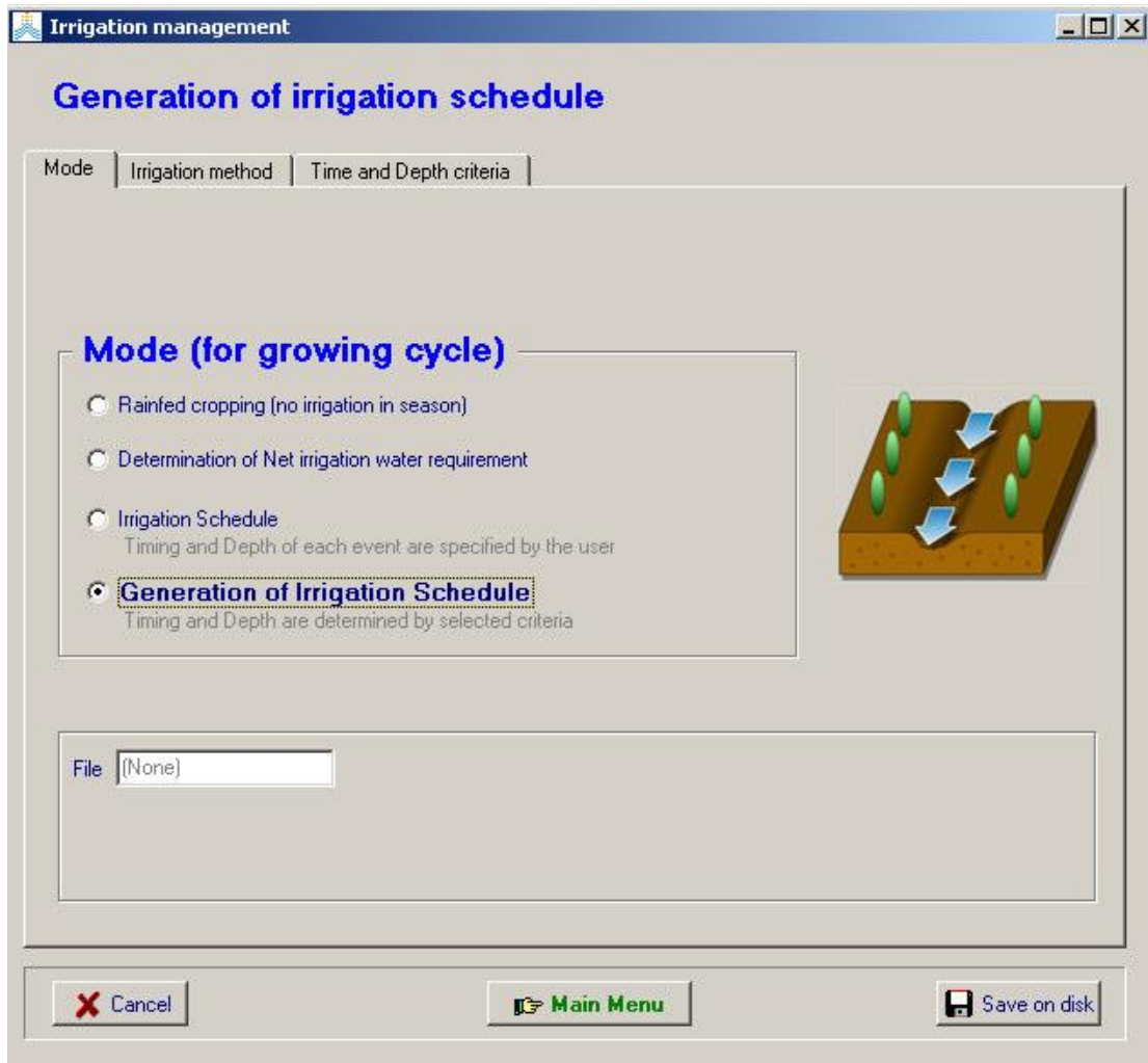
الشكل a12.2: اختيار نمط الري mode من قائمة إدارة الري Irrigation management.
