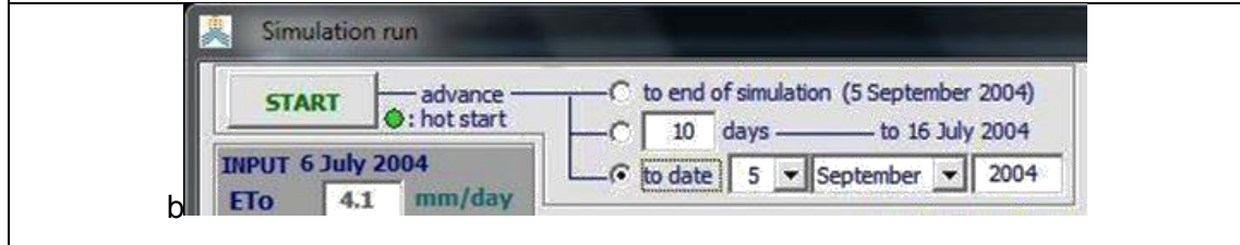
شكل 17.2h: تحديد التاريخ الذي يجب أن يتقدم إليه التشغيل، في بداية تشغيل المحاكاة، في لوحة التقدم advance في قائمة تشغيل المحاكاة Simulation run
