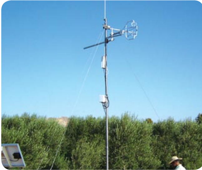
محطة Eddy Covariance لقياس الاحتياجات المائية لأشجار الزيتون في مشروع أبو عيشه
